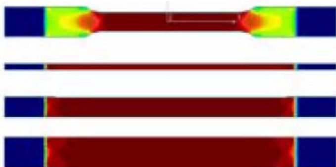
図2. 引張り試験サンプルの有限要素解析モデル
